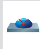
Nízká povrchová energie Polypropylen, polyetylen, TPO, teflon, acetyl, PBT, polystyren, pryž EPDM. Některé barvy a nátěry (PVDF)
