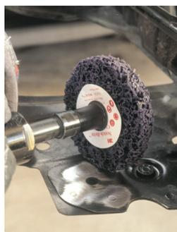
Odolné a výkonné kotouče Clean & Strip jsou dokonalou a bezpečnou alternativou drátěných kartáčů a drátěných kotoučů. Používají se při otáčkách 3500–4500 ot./min.
