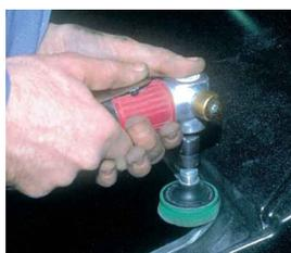
Různé typy brusných kotoučků v malých průměrech s upínacím systémem „Roloc“ pro jednoduchou a rychlou výměnu.
